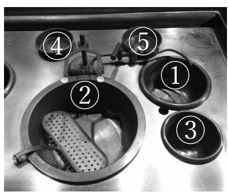
フランス式繰糸器復元機 (繰糸所内設置)
